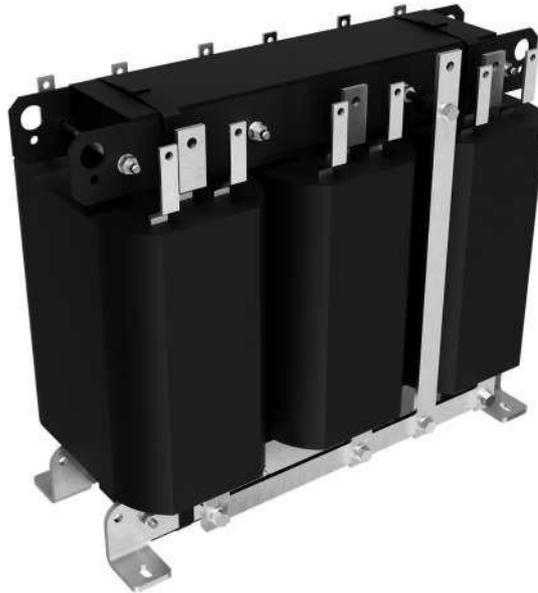
O transformador de saída de 400 Hz reduz as tensões dos módulos inversores DIM para a tensão necessária da aeronave. Cada transformador tem quatro conjuntos de enrolamentos primários (DDDDyn), onde cada conjunto é alimentado por um módulo DIM. Um transformador pode lidar com um total de até 90 kVA de potência de saída. Para classificações de potência maiores que 90 kVA, um segundo transformador é necessário.
