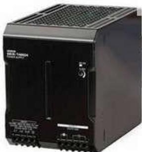
A unidade de fonte de alimentação de 24 V DC é a fonte de alimentação comum para componentes PLC, unidade de exibição e ventiladores de resfriamento. Ela tem uma faixa de tensão de entrada de 340 V a 550 V.
