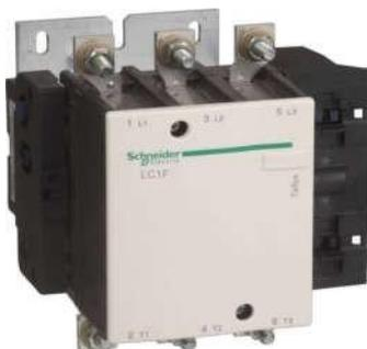
O contator de saída conecta a tensão do transformador de saída ao cabeamento de 400Hz da aeronave. Em caso de erros internos ou externos, ou quando a unidade para regularmente, o contator desconecta imediatamente a tomada. Isso garante que o cabeamento de saída conectado esteja desenergizado e seguro.
